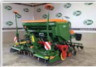
AMAZONE Säkombination , Bj. 2022, Kreiselegge KE 3002 – 240, Güttler Walze, Sämaschine Cataya 3000 Super mit RoTeC Schare, Spuranzeiger, Voraufmarkierung, ISOBUS, 45.360.- inkl. 20%
