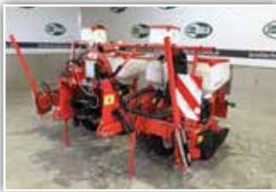
GASPARDO Maissämaschine MTR 4 Reihen , MTR Säaggregat mit Doppelscheibenschär, V Andruckrollen, Spuranreißer, Beleuchtung, Gelenkwelle, Optional Mikrogranulatstreuer
