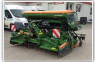
AMAZONE Säkombination KE 3001 mit Cataya 3000 Special , Neumaschine, elektrische Fahrgassenschaltung, mechanischer Antrieb, RoTeC Scheibenschare, Exakttsriegel
