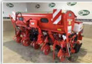
GASPARDO Maissämaschine MTR 5 Reihen ISOTRONIC , MTR Säaggregat mit Doppelscheibenschär, V Andruckrollen, elektrischer Säntrieb mit ISOBUS Elektronik, Düngertank 1200 Liter
