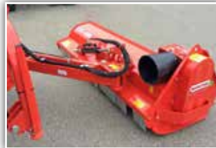
MASCHIO Giraffa 210 XL Seitenmulcher, Vorführmaschine , Antriebsgetriebe außenliegend, Gleitkufen, 540 U/min, Stützwalze, Gegenschneide, Arbeitsbreite 210 cm, hydr. Neigungsverstellung +90 bis -65 Grad
