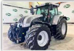
STEYR CVT 6190 Profimodell , Bj. 2004, 8.740 h, FH, gef. Vorderachse, gef. Kabine, Bereifung 600/65 R28 vorne und 710/70 R38 hinten, hydr. Oberlenker, Maschine in gutem Zustand, 64.800,- inkl. Verm.
