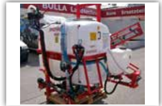
GASPARDO Sauro 800 Liter , 12 Meter Arbeitsbreite, Gestänge mechanisch oder hydraulisch klappbar, 5 Teilbreiten, Reinwassertank, Einspülschleuse, Handwassertank, Gestänge höhenverstellbar
