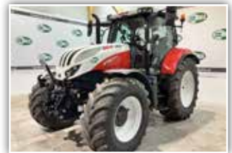
STEYR Profi 4125 S8 , Bj. 2023, 500 h, Miettraktor, 50 km/h, 8-fach Lastschaltgetriebe, gefederte Vorderachse, gefederte Kabine, 540/65 R28 vorne, 650/65 R38 hinten, Easy Tronic, S-Tech 700 Monitor
