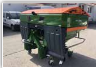
AMAZONE ZA-V 2000 Profis Control , Bj. 2023, Wiegestreuer, Rollplane, schwenkbare Abstellvorrichtung, Neigungssensor, Inhalt 2000 Liter, Schmutzfänger, Beleuchtung, Gelenkwelle
