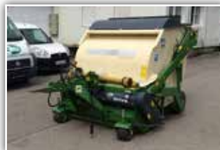
AMAZONE GHS Drive 1500 , Vorführmaschine, Deichselanhangung, Arbeitsbreite 150 cm, Hochkippeinrichtung 230 cm, Exaktschnittrotor mit Zwangsförderung, Flügelmesser und/oder Vertikutiermesser
