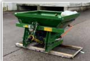
AMAZONE ZA-X 603 Easy , Neumaschine, 600 Liter Inhalt, geschwindigkeitsabhängige Regelung, Einfüllsiebe, Amaspread 2 Bediencomputer, Gelenkwelle
