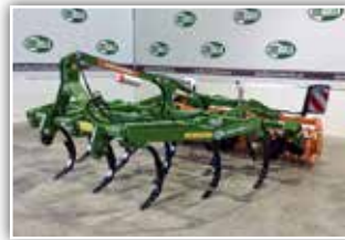
AMAZONE Cenius 3003 , Neumaschine, Winkelwalze mit Federmessersystem vorne, hydraulische Tiefenverstellung, Einebnungsscheiben, Randpadel zur Anebnung, Beleuchtung
