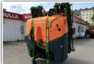
AMAZONE UF 1602 , Bj. 2024, ISOBUS Elektronik mit Amatron 4, 21/15 Meter Gestängebreite mit Reduzierung, DUS Umlaufsystem, Comfort Reinigungspaket, Profi Klappung 1 mit Load Sening und Distance Control
