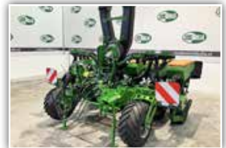
AMAZONE Precea 4500-2 Super , Neumaschine, 6 Reihen, variabler Reihenabstand 45/50/60/65/70/75 cm, ISOBUS Elektronik, Säuberung, Mikrogranulatstreuer elektrisch
