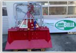
TAJFUN EGV 65 AHK SG Seilwinde , Neumaschine, Schildbreite 180 cm, Soma Profifunk, 110 Meter – 10 mm Forstseil, Seilendstück drehbar
