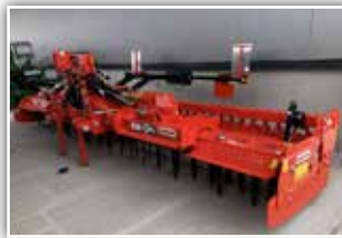
MASCHIO Falco 5000 Kreiselegge , hydr. klappbar, Zahnpackerwalze, Gelenkwelle mit Nockenschaltkupplung, gefederte Seitenschilder, Beleuchtung
