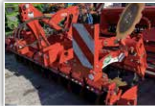
MASCHIO Veloce 300 Scheibenegge , Vorführgerät, 2 Reihe gezackte Scheiben mit 51 cm Durchmesser, hydraulische Tiefenstellung, Stabwalze, Beleuchtung, wenig gearbeitet
