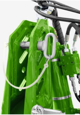
Optimale Kraftübertragung auch bei unterschiedlichen Traktoren durch 4 verschiedene Anbaupunkte für den Oberlenker
