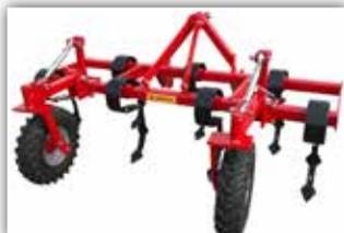
**BRIX Goliath Frontgrubber**, Neumaschine, Bj. 2023, 2 balkig, 7 Zinken mit Doppelherzschare, 2 Lenkräder 7,00 - 12, Beleuchtung
