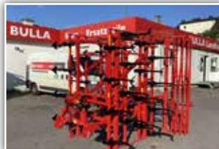
**BRIX Unimax 500 Leichtgrubber**, Neumaschine, Bj. 2021, 32 Gänsefußschare mit 70x12 mm, Zerstreicher, Stabwalze
