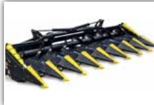
**OLIMAC Drago GT**, Neumaschinen von 4 bis 16 Reihen, gedämpfte selbstjustierende Pflückplatten, gehärtete Pflückschienen, 70 bis 80 cm Reihenabstand, Unterbauhäcksler horizontal doppelt ausgeführt, Ersatzteilstützpunkt in Sierning
