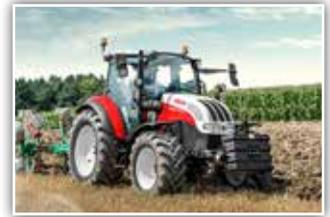
**STEYR Kompakt 4110 HD**, Neumaschine, Stufe V - neue Motorgeneration, Bj. 2022, HD Achsen mit mehr Spurweite, 40 km/h ECO Getriebe, Power Shuttle, Lastschaltung, Bereifung 440/65 R24 und 540/65 R34, 5x DW mit Kreuzhebel
