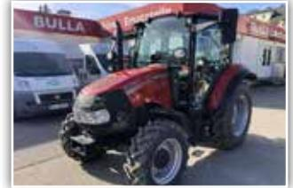
**CASE IH Farmall 55 C**, Neumaschine, Bj. 2022, 12/12 Synchro Shuttle Getriebe, 40 km/h, Bereifung 14.9 R20 vorne und 16.9 R30 hinten, Luftsitz mit Horizontalfederung, 3x DW, Zusatzhubzylinder
