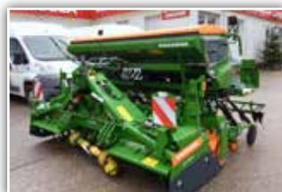
**AMAZONE Säkombination KE 3001 Super**/Cataya 3000 Special RoTeC, Neumaschine, Bj. 2022, 24 Schäre, mechanischer Säantrieb, Amalg+ Fahrgassenschaltung, Zahnpackerwalze
