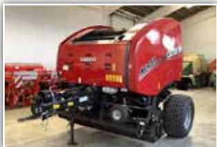
**CASE IH RB 455**, Neumaschine, Bj. 2022, Durchmesser von 90 - 150 cm, 235 cm PickUp, Bereifung 500/55 - 20, 15 Messer, 4 Endlosriemen, Weichkerneinrichtung, ISOBUS mit AFS 700 Monitor, DLA
