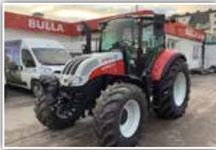
**STEYR Multi 4120**, Neumaschine, Bereifung 480/65 R24 vorne und 600/65 R34 hinten, LED Arbeitsscheinwerfer, Drehlicht, DLA, Klima, FH, gef. VA, gef. Kab., S-Stop, Premium Luftsitz, 4x DW, 100 l/min Pumpe
