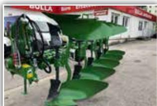
**AMAZONE Cayros XMS-V Pflug 5 Schar**, Neumaschine, Bj. 2023, Molblech WL 430 mit Meißel, Einschwenkvorrichtung, Scharabstand 105 cm, Rahmenhöhe 82 cm, Schnittbreite hydr. verstellbar, Pendelstützrad 680 mm
