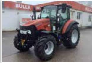
**CASE IH Farmall 90 C**, Bj. 2022, Neumaschine, 24/24 Gang Getriebe mit Power Shuttle und Lastschaltung, Bereifung 440/65 R20 und 540/65 R30, 5x DW, Klima, Luftsitz
