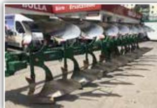
**REGENT TAURUS 200 SCX Aufsattel Drehpflug**, 8 Schar Pflug, Bj. 2002, hydr. Schnittbreitenverstellung, Vorschäler, Scheibensech gezackt, Unterlenkerachse Kat III, 17.600.- inkl. 20% UST
