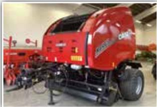
**CASE IH RB 465**, Neumaschine, Bj. 2022, Durchmesser von 90 - 180 cm, 235 cm PickUp, Bereifung 500/55 - 20, 15 Messer, 4 Endlosriemen, Weichkerneinrichtung, ISOBUS mit AFS 700 Monitor, DLA
