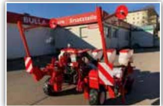
**GASPARDO Monica**, Neumaschine, Bj. 2022, 6 reihig, hydraulisch teleskopierbar, Reihenabstände 45 / 50 / 70 / 75 cm möglich, Transportbreite 255 cm, ohne Düngertank, hydr. Spuranzeiger, Samen- und V-Andruckrollen, ISOBUS
