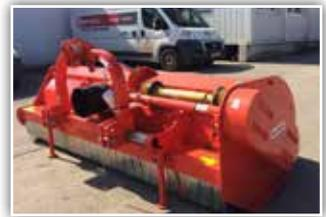
**MASCHIO Tornado 280 Mulcher**, Neumaschine, Bj. 2023, Heckgerät mit hohem Rotor, Freilauf integriert, Y-Messer, Walze, GW
