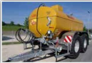
**VAKUTEC MKE 14 PU Light ECO Pumpfass**, Neumaschine 40 km/h Typisierung, DLA mit ALB, Unten-anhängung mit K80, Pendel Trapez Lenkachse, Schleppschuhvorbereitung
