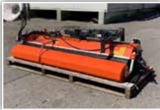
**TUCHEL Eco 520/260**, Neumaschine, Bj. 2021, 260 cm gerade und 244 cm schräge Arbeitsbreite, Seitenbesen, hydraulische Schmutzladenöffnung, 3 Punkt Anhängung mit 3ten Stützrad, hydraulischer Antrieb
