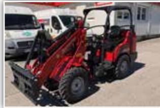
**SCHÄFFER Hofader 2028 SLT**, Neumaschine, Bj. 2021, 25 PS Dieselmotor, Bereifung 7,00-12 AS oder Breitreifen möglich, Ölkühler, Heckgewicht Endplatte, 1x LED Arbeitsscheinwerfer, Schnellwechsellrahmen mit hydr. Verriegelung
