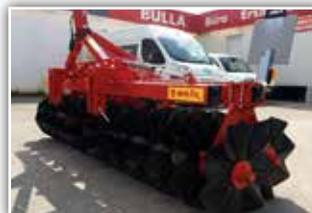
**BRIX Twinn 300 Frontwalze**, Neumaschine, Bj. 2022, 2 reihig mit Wellenscheiben, 560 mm Durchmesser, Beleuchtung
