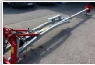
**VAKUTEC TMH Profi 6 Meter Güllemixer**, Neumaschine, Bj. 2022, massives 4 Kant Rohr, Neigungsverstellung hydraulisch, Stützfußverbreiterung, Schwenkeinrichtung hydraulisch, Rührflügel HE 25
