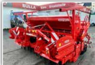
**MASCHIO Säkombination DC Classic 3000 / Dama 300 New Edition**, Neumaschine, Bj. 2022, 3 Meter, Kombipackerwalze, 24 Doppelscheibenschar Corex Plus mit Samenandruckrollen, Striegel, GW mit Nockenschaltkupplung
