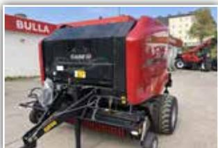
**CASE IH RB 344**, Neumaschine, neues Modell, Bj. 2022, Fixkammer 125 cm, Bereifung 19.0/45-17, 200 cm PickUp, 15 Messer mit Gruppenschaltung, Bedienmonitor, Dichteeinstellung über Monitor, WWGW, autom. Kettenschmierung
