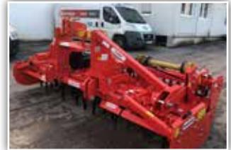
**MASCHIO DC Classic 3000 Kreiselegge**, Neumaschine, Bj. 2023, 3 Meter Arbeitsbreite, Zahnpackerwalze 500 mm, GW mit Nockenschaltkupplung
