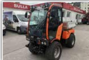
**HOLDER C 270**, 67 PS Motor, 40 km/h stufenloses Getriebe, Knicklenkung, FH, FZW, Klimaanlage, Luftsitz, Joystick Bedienung, guter Zustand, 54.240.- inkl. 20% UST
