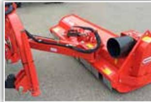
**MASCHIO Giraffa 210 SE Seitenmulcher**, Neumaschine, Bj. 2023, Auslegermulcher seitlich und hochstellbar, Getriebe außen, Hämmer, Walze, WWGE
