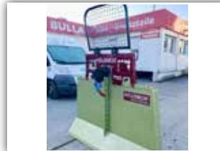
**HOLZKNECHT HS 750 Seilwinde**, Neumaschine, Bj. 2023, 7,5 Tonnen Zugkraft, 100 Meter - 11 mm gehämmert mit Parallelhaken, Autec Funk, Seilausstoß hydraulisch, Schildbreite 190 cm, Kipp Stop
