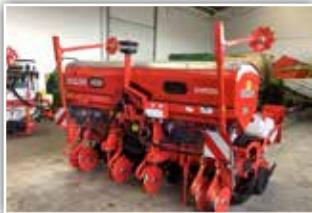
**GASPARDO Chrono Maissämaschine**, Neumaschine, Bj. 2023, 6 reihig, Reihenabstand 75 cm, HIGH SPEED Sätechnik, Düngertank, elektrischer Säantrieb, hydraulisch angetr. Kompressor, Räumsterne, Schneidscheiben, ISOBUS
