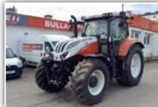
**STEYR Profi 4125 S8**, Mietmaschine, Bj. 2021, 600 h, 50 km/h - 24/24 - 8-fach Lastschaltgetriebe, Bereifung 480/65 R28 vorne und 600/65 R38 hinten, gef. VA, gef. Kab.
