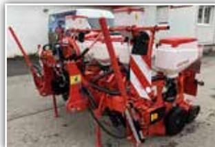
**GASPARDO MTR**, Neumaschine, Bj. 2021, 4 reihig, ohne Düngertank, Mikrogranulatstreuer 2x 30 Liter, MTR Säaggregat, Samen- und V-Andruckrollen, hydr. Spuranzeiger, ISOBUS mit Säuberwacheung
