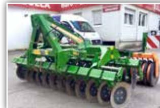
**AMAZONE Catros 3001**, Bj. 2022, glatte Scheiben für exaktes flaches Bearbeiten, Keilringwalze 580 mm, hydraulische Tiefenverstellung
