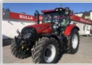
**CASE IH Maxxum CVX 150**, Bj. 2022, Neumaschine, 50 km/h, gef. VA, gef. Kab., Bereifung 540/65 R28 vorne und 650/65 R38 hinten, 5x DW, Grammer Dual Motion, AFS 700 Monitor, FH und FZW, HMC 2
