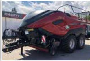
**CASE IH Quaderballenpresse LB 436 HD**, Bj. 2021, Ballenmaß 120 x 90 cm, Pick Up 235 cm, 2 Gang Startgetriebe für leichtes Starten und extrem hohe Schwungmasse, 62 to Hubkraft, hydr. Garnkästen, hydr. Fahrwerk, TWINE Pro Knoter
