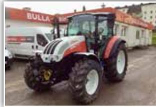
**STEYR Kompakt 4090**, Stufe V, Bj. 2022, 150 h, Fahrschultraktor, 24/24 Power Shuttle mit Lastschaltung, 40 Eco Getriebe, Bereifung 440/65 R24 vorne und 540/65 R34 hinten, FH und FZW, 5x DW mit Kreuzhebel, DLA, Klima
