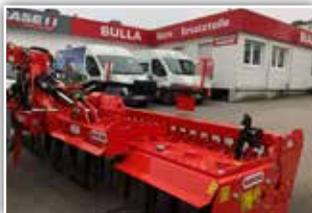
**MASCHIO Falca 5000 HD Kreiselegge**, Neumaschine, Bj. 2023, 5 Meter Arbeitsbreite, hydraulisch klappbar, Zahnpackerwalze 500 mm, GW mit Nockenschaltkupplung
