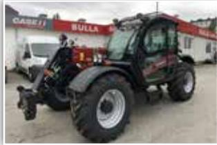
**CASE IH Farmlift 742**, Bj. 2022, 300 h, Vorführer, 6x3 Powershift Getriebe mit Wandler und Schaltautomatik, Allradlenkung, Umkehrlüfter, Bereifung 460/70 R24 Trelleborg, LED Arbeitsbeleuchtung, autom. AHV
