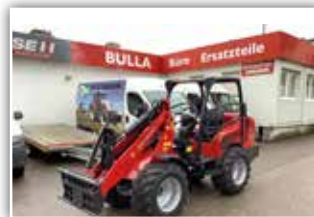
SCHÄFFER Hoflader 3650SLT , Neumaschine, Bj. 2022, 50 PS Dieselmotor, Bereifung 31x15.5 - 15 AS mit ET 70 mm, Euro Aufnahme, Selbstperrdifferential in Vorder- und Hinterachse
