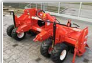
MASCHIO BIO SC Pro 280 Fräse , Neumaschine, Bj. 2022, hydraulische Heckklappe, 4x Stückräder vorne mit 22x11.00 - 10, Doppelmessersfahrschiff, GW mit Nockenschaltkupplung
