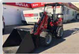
SCHÄFFER Hoflader 2032 , Bj. 2019, Vorführer, 30 PS Dieselmotor, Axialkolbenpumpe, Bereifung 31x15.5 - 15 AS, Schnellwechselrahmen mit hydraulischer Verriegelung, Zusatzhydraulikkreis
