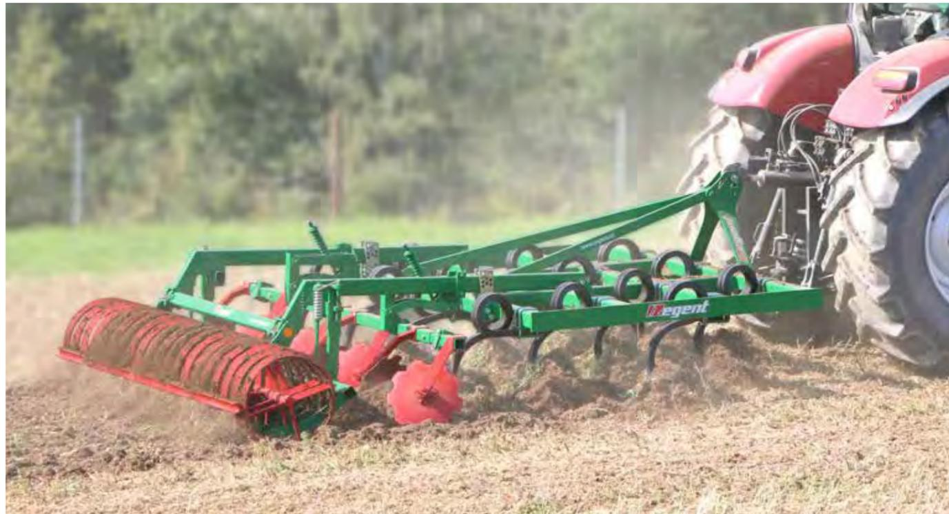
Der multifunktionale Mulch-/Schwergrubber für jede Einsatzmöglichkeit – der ideale Begleiter auf Ihren Feldern. Im Parallelogramm aufgehängte Scheiben sorgen für eine optimale Einebnung, diese sind stufenlos einstellbar und überlastgesichert.
