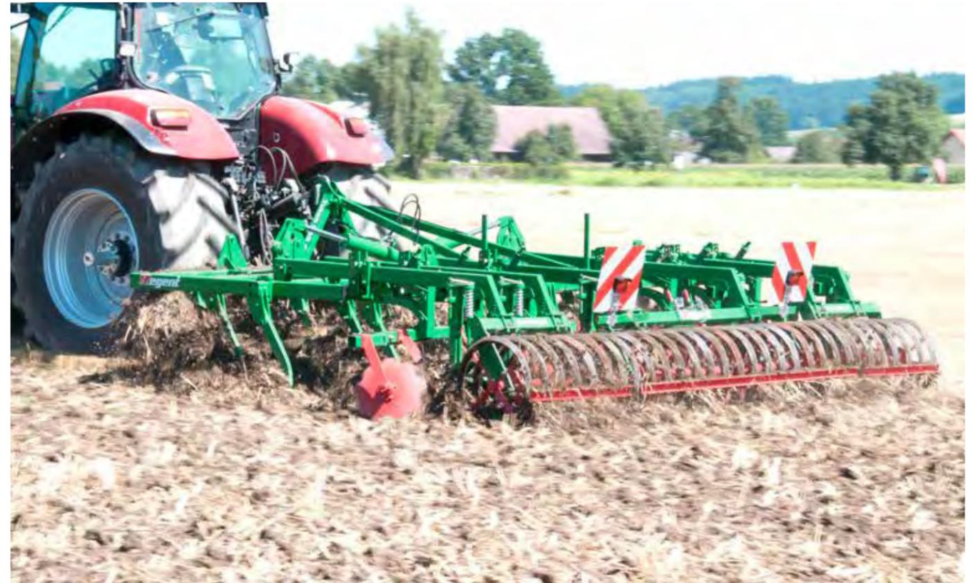
Der Tukan DSG in 4-balkiger Ausführung eignet sich für mittlere bis schwere Böden bei einer Arbeitstiefe ab zirka 10 cm bis 30 cm.
