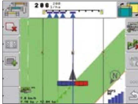
Diese App sorgt für GPS-gesteuertes Ein- und Ausschalten von Maschinen, Maschinenteilbreiten oder Einzeldüsen. Section-Control kann bis zu 72 Teilbreiten oder Einzeldüsen steuern. Die App entspricht der ISOBUS-Norm.
