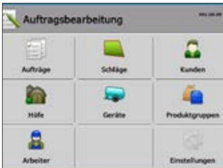
Diese App aktiviert den TASK-Controller (TC) und damit die ISOBUS-Auftragsbearbeitung. Sie ist das Bindeglied zwischen der Farm Management Information Software (FMIS) am Arbeitsplatz und der Gerätesteuerung auf der Maschine. Die App erfasst die Arbeiten auf dem Feld automatisch – im einfachen Fall schlagbezogen oder, bei Precision Farming, positionsbezogen mit GPS. Der Datentransfer erfolgt per USB-Stick oder über farmipilot.
