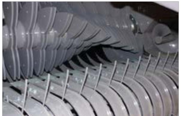
Schneidwerk mit Spiralrotor
