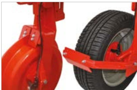
Stahl- oder Gummiräder mit Geschwindigkeitssensor
