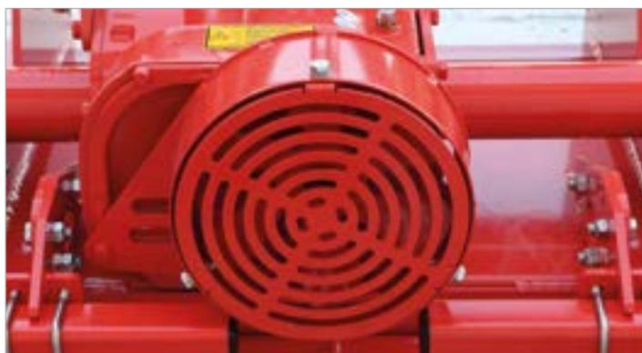
Ölbad-Wechselradgetriebe mit Luftkühlung
