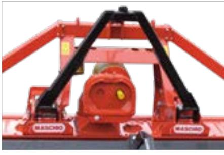
Aufsatteldreieck für pneumatische Drillmaschine (Fremdfabrikat)
