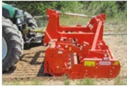
Frontanbauboock inkl. Walterscheid-Gelenkwelle für Front, Mindesthöhe Zapfwellenstummel am Schlepper = 770 mm
