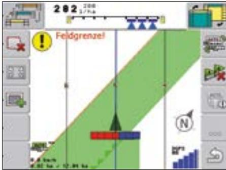
Diese App ermöglicht auch bei schlechter Sicht, in Verbindung mit einem D-GPS Empfänger, ein exaktes Fahren paralleler Spuren im A/B-, A+-, Multi A-B, Kreis-, Vorgewende- oder Kontur-Modus. Außerdem lassen sich Hindernisse markieren und mit Felddaten, wie Grenzen und Spuren, abspeichern. Unterbrochene Arbeitsvorgänge lassen sich speichern und jederzeit fortsetzen.
