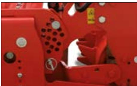
Seitliche Walzenaufnahme mit Bolzenverstellung der Walze
