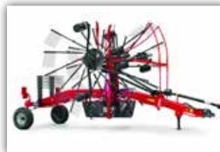
**SIP Doppelschwader**, Star 600 bis 1000, 6 bis 10 Meter Arbeitsbreite, Tandemkreiselfahrwerk
