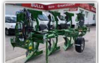
**AMAZONE Cayros XM 950 4 Schar**, Mollblech W430, Arbeitsbreite hydr. Verstellbar, Scheibensech gezackt, Pendelstützrad, Rahmenrohr 150 x 100 x 8 mm
