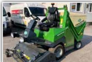
**AMAZONE Profihopper 1250 4 WDI**, Bj. 2020, Vorfürer, 125 cm Arbeitsbreite, Exaktschnittrotor SmartCut mit 72 Messer (36 Paar), Hydrostat
