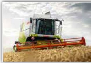
**CLAAS Tucano Montana**, 430 bis 580 von 286 bis 381 PS mit Mercedes Motoren mit Stufe V, Montana Hangausgleich, Korntankvolumen 8.000 bis 11.000 Liter
