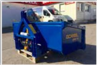
**GÖWEIL GHU 10/2200**, 3,5 Tonnen Nutzlast, 2,2 Meter x 1 Meter, Bordwandschwenkvorrichtung, Hardox Schürfleiste
