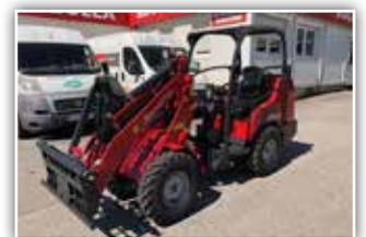
**SCHÄFFER 2028 SLT**, Neumaschine, Bereifung 7.00-12 AS, ET +40 Wendefelgen, Hubkraft 1500 kg, hydrostatischer Allradantrieb, Schnellwechslerahmen mit hydraulischer Verriegelung
