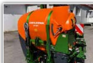
**AMAZONE UF 901**, 1050 Liter Inhalt, 12 Meter Q-Plus Gestänge, 5 elektr. Teilbreiten, hydr Klappbar, hydr. Höhenverstellbar, Einspülschleuse, Reinwassertank
