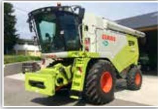
**CLAAS Tucano 430 - Stufe 5**, Neumaschine, APS Druschsystem, Auto Contour, Bereifung 800/70 R32, elektr. Siebverstellung, 3-D Siebe, SW frei wählbar
