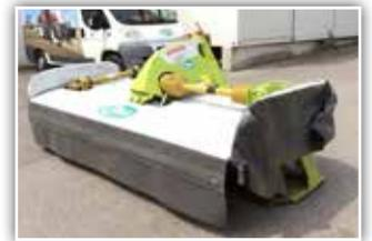
**CLAAS Mähwerk Disco 3150 F Pofil**, MaxCut Mähbalken, Messerschnellwechsel, klappbare Seitenschutztücher, Schwadscheibe, Fördertrommel links, Gelenkwelle, Entlastungsfedern
