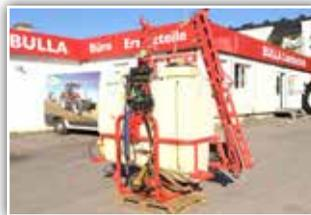
**AGRO Star 1000 Liter**, 12 Meter, Arbeitsbreite mit Anfahrerschutz, hydraulische Klappung, mechanische Höhenverstellung, Pendelausgleich, Einspülschleuse, Reinwassertank, elektr. Teilbreitenschaltung und Druckverstellung, 5.950.- inkl.
