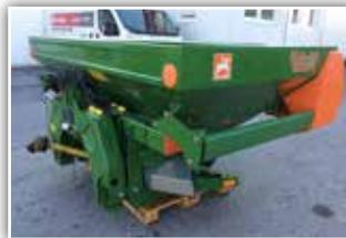
**AMAZONE ZA-M 1001 Profis**, Wiegestreuer, Zweischeibenstreuer, 1200 Liter, Grenzstreueinrichtung Limiter, Bedienterminal Amatron +, Einfüllsiebe, Top Zustand, 8.950.- inkl.
