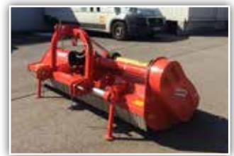
**MASCHIO Brava 250**, Getriebe 540 U/min mit Freilauf, Hammerschlegel, untere Gegenschneide, spiralförmige Werkzeuganordnung
