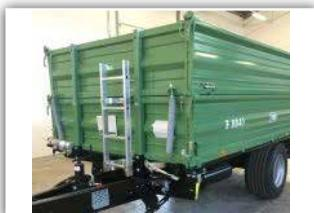
**BRANTNER E 8041**, DLA, Bordwände 2 x 60 cm, 4,07 m x 2,08 m, 5 mm Boden, Pendelwände links und rechts mit Zentralverriegelung, BHF, abklappbare Bordwände, Bereifung 445/45 R19,5
