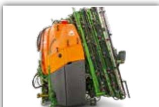
**AMAZONE UF 1302**, Teilbreitenschaltung, Reinwassertank, Einspülschleuse, Befüllstop, Schwenk- und Abstellvorrichtung, SuperS-Gestänge
