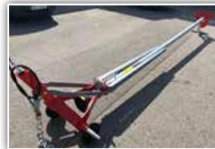
**VAKUTEC Güllmischer TMSH 5 m**, Neugerät, Rührflügel HE 19, Stützfuß, hydr. Neigungsverstellung, 2.950.- inkl
