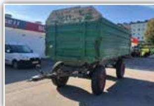
**STETZL 3 Seitenkipper**, 12 to. Gesamtgewicht, 9 to. Nutzlast, Bj.: 1984, 1 Leiter Druckluftanlage, Länge 440 cm, Breite: 215 cm, Plateauhöhe 130 cm, 5.600.- inkl.
