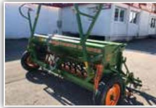
**AMAZONE DB - 30 Super**, Fahrgassenschaltung, hydr. Schardruckverstellung, stufenlos Getriebe zur Saatmengenverstellung, Exaktstriegel, Spuranreisser, sehr guter Zustand, 3.200.- inkl.
