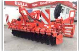
**MASCHIO Veloce 300**, Scheibendurchmesser 510 mm, gezackte Scheiben, Steinsicherung, Stabwalze 450 mm Durchmesser
