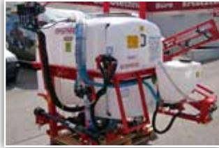
**GASPARDO Sauro 800**, 12 Meter Arbeitsbreite, mechanisch klappbar, Einspülchleuse, Reinwassertank, 5 Teilbreiten
