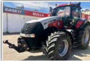
**CASE IH Magnum 340**, Bj. 2013, 4650 h, 50 km/h Getriebe, 19/6 Full-Powershift Getriebe, Power Shuttle, Bereifung hinten: 800/70 R 38, vorne: 600/70 R 30, 5 x DW, Power Beyond Anschlüsse, 95.500.- inkl.
