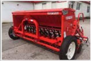
**GASPARDO Nina 300**, Corex Scheibenschare, Saattank 550 Liter, Normal und Feinsärad, stufenlos Getriebe, Fahrgassenschaltung
