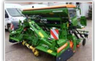
**AMAZONE Cataya 3000 Special**, Ausstellungsmaschine, KE special, Zahnpackerwalze, RoTec Scheibenschar, Exaktstriegel, mechanischer Säntrieb
