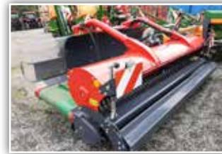
**SIP Air 300f Alp**, Pick Up Schwader, Arbeitsbreite 295 cm + Schwadbreite, Förderbandbreite 70 cm, hydro-pneumatische Entlastung
