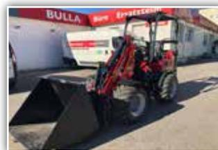
**SCHÄFFER 2032**, Bj.: 2019, 80 h, Vorführer, Hubkraft 1600 kg, Hochdruck Axialkolbenpumpe, 20 km/h, Joystick mit Vorwärts/Rückwärts Taster, Bereifung: 31x15,5 – 15 AS
