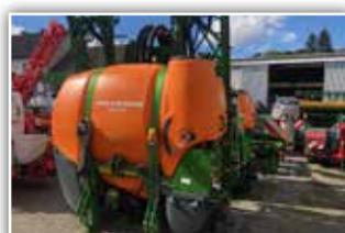
**AMAZONE UF 1201**, 15/12 Meter SuperS-Gestänge, Einspülschleuse, Reinwassertank, geschwindigkeitsabhängige Regelung mit Amaspray+
