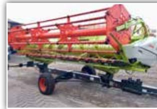
**CLAAS Cerio 560**, Bj. 2018, 560 cm Arbeitsbreite, Auto Contour Schneidwerksführung, Halnteiler lang, Schneidwerkslänge manuell verstellbar, Claas Transportwagen einachsrig mit Bremse
