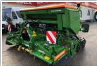
**AMAZONE Cataya 3000 Super**, Säkombi, KE Super, Zahnpackerwalze 600, elektrischer Säntrieb, ISOBUS, Doppelscheibenschar Twin Tec, LED Beleuchtung
