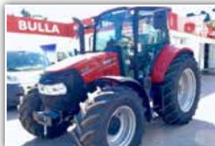
**CASE IH Luxxum 100**, 32/32 Gang - 40 km/h ECO Getriebe, Power Shuttle, 4-fach Lastschaltung mit Automatik, Klimaanlage, Bereifung 600/65 R34
