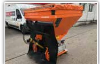
**AMAZONE Winterdienststreuer E+S 751**, Antrieb mit Gelenkwelle, hydraulische Schieberöffnung, Fingerührwerk für Sand und Salz, Schmutzfänger, Behälteraufsatz, Abdeckhaube, Streuwerk aus Edelstahl, 1110 Liter
