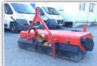
**HYDRAC Kehrmachine 2 Meter**, Arbeitsbreite 2,2 m Außenbreite, Kehrbürste 50 Durchmesser, 3 - Punkt Anbau, Schmutzwanne - mechanisch zu entleeren, Tasträder
