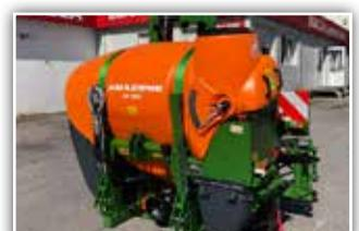
**AMAZONE UF 901**, 15 Meter Gestänge, elektr. Teilbreiten, hydr. Höhenverstellbar und klappbar, Reinwassertank, Handwaschbehälter
