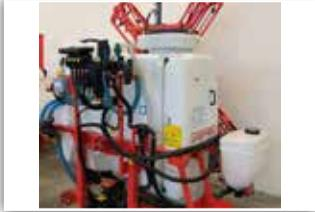
**GASPARDO Teko 1000 X**, 1100 Liter, Frischwassertank, 12 m Gestänge, hydr. Klappbar, hydr. Höhenverstellbar, Einspülchleuse, Innenreinigung mit Rotationsdüse
