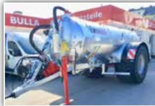
**VAKUTEC Güllfass VA 9500**, Neumaschine, DLA mit ALB, Bereifung 850/50 R 30,5, gekröpfte Achse, Untenanhängung V-Deichsel, WGWG mit Freilauf, Halte-Kupplung für Prallkopfverteiler
