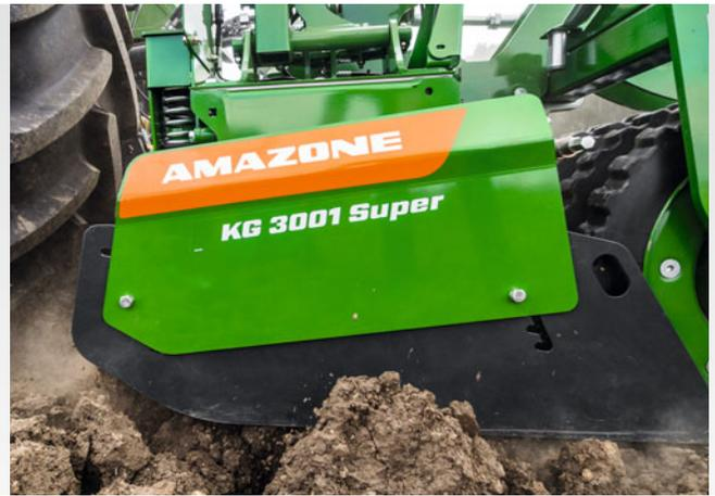
❗ „Das untere Verschleißblech lässt sich komfortabel in der Tiefe verstellen: Schrauben lösen und das Blech in die gewünschte „Raste“ einschieben, Schrauben anziehen, fertig.“
