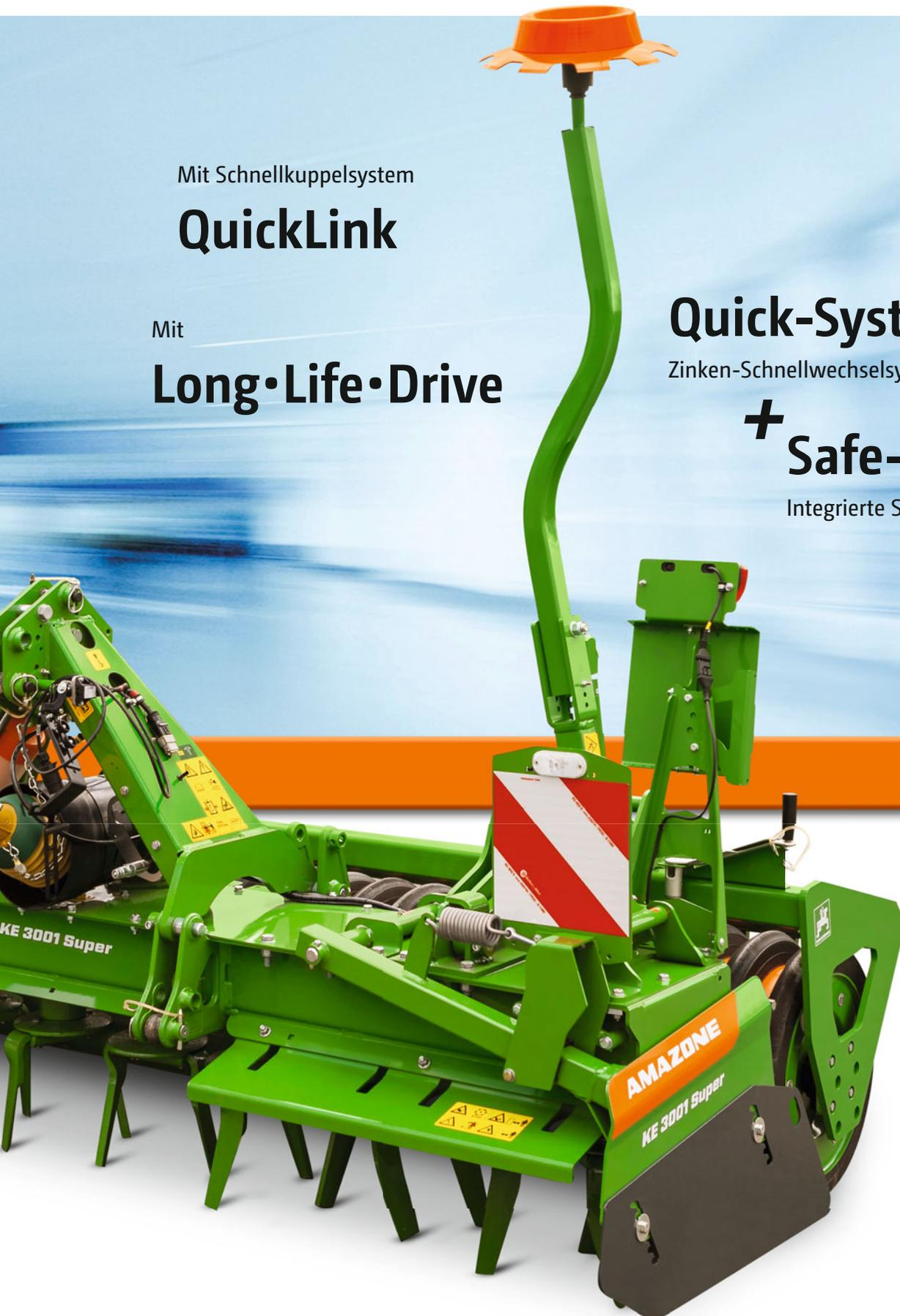
Die Kreiseleggen KE und die Kreiselgrubber KX und KG mit Arbeitsbreiten von 2,5 m bis 4 m eignen sich ideal für den Soloeinsatz oder in Kombination mit einer Aufbausämaschine zur Saat. Ausgestattet mit der passenden Walze wird eine sehr gute Rückverfestigung erzielt.
