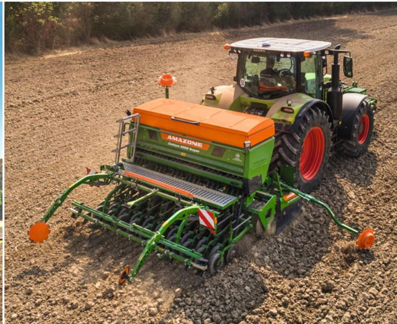
Dank dem Huckepack-System und dem Schnellkuppelsystem QuickLink lassen sich verschiedenste Säkombinationen realisieren
