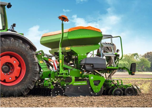
Aufbausämaschine Centaya 3000 Super mit der Anbau-Kompaktscheibenegge CombiDisc 3000
