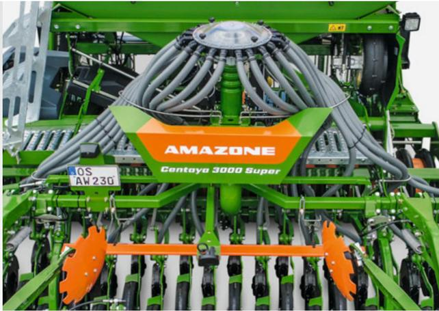
Centaya Super mit Segmentverteilerkopf
