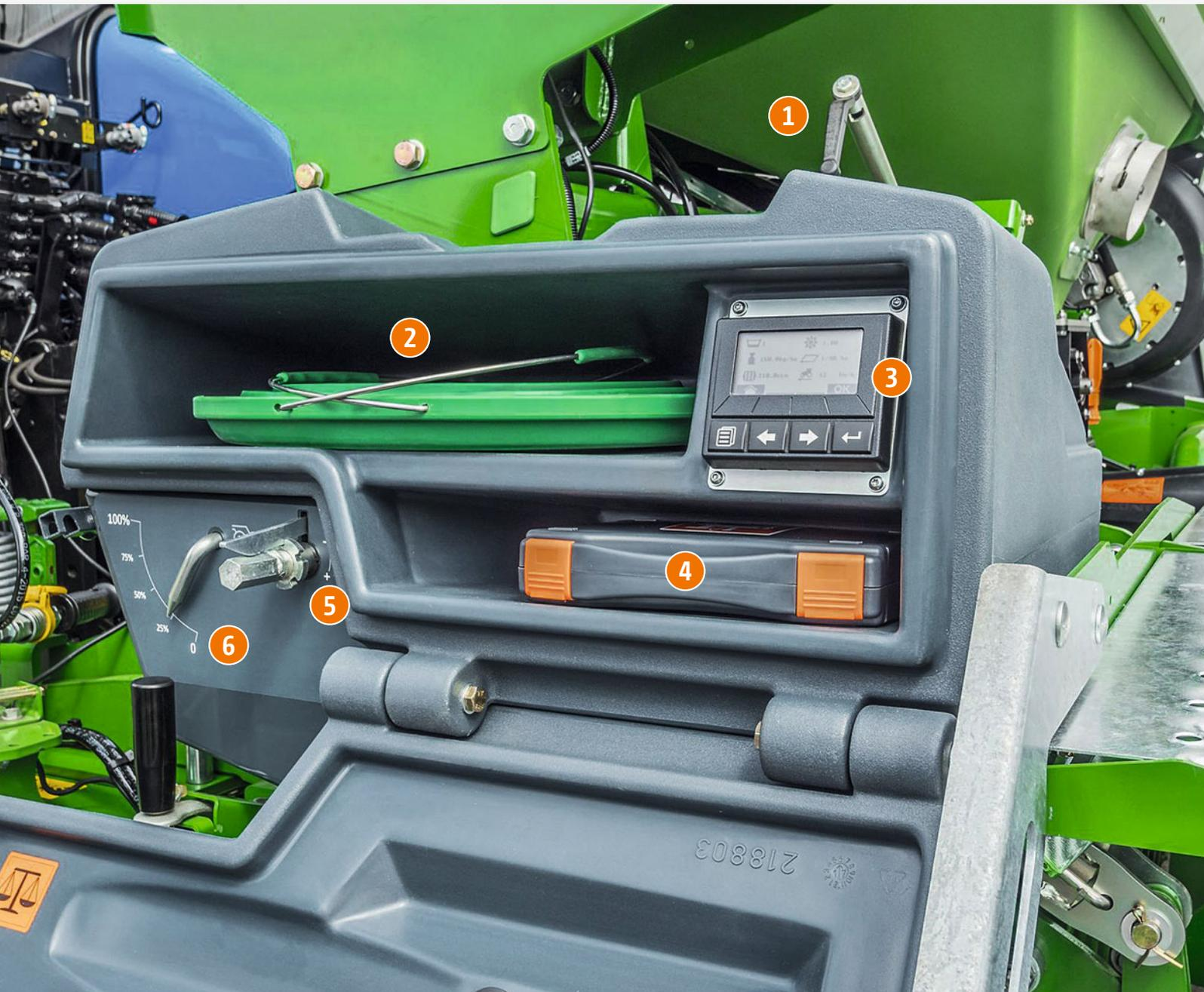
✓ SmartCenter an der Centaya 3000 Super mit TwinTeC-Scharsystem und hydraulischer Schardruckverstellung
