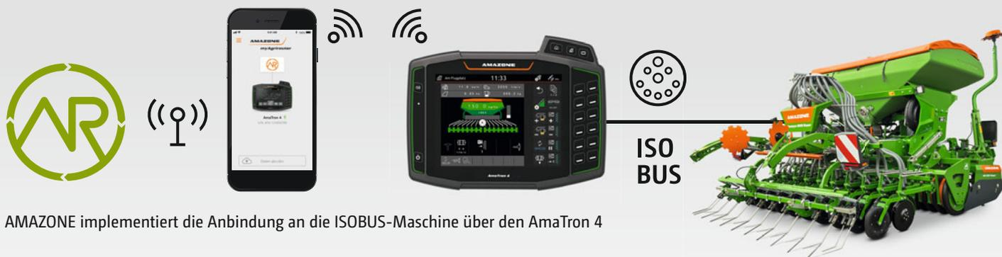
AMAZONE implementiert die Anbindung an die ISOBUS-Maschine über den AmaTron 4
