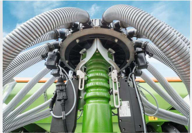
Segmentverteilerkopf mit elektrischer Halbseitenschaltung
