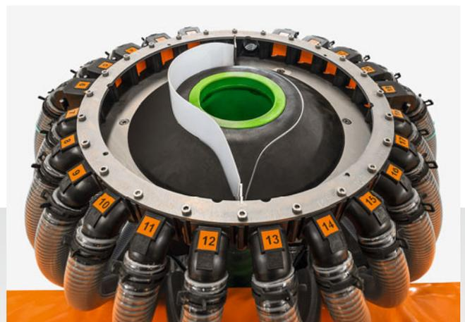
Segmentverteilerkopf mit elektrischer Halbseitenschaltung (aktiviert)
