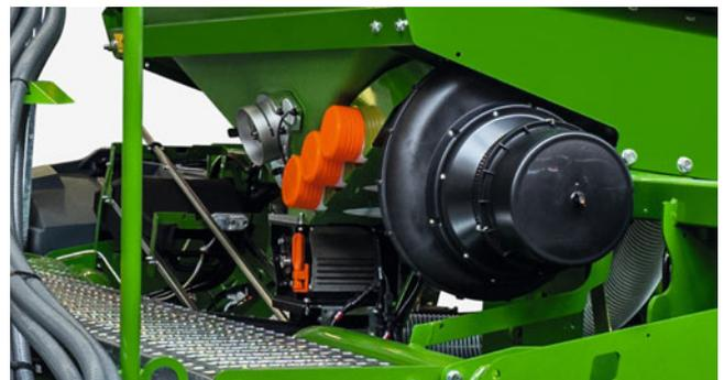
✔ Ein optionaler Zyklonabscheider reduziert die Staubbelastung und erhöht die Einsatzsicherheit
