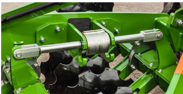
✔ Arbeitstiefeneinstellung durch Distanzelemente – hier flache Arbeitstiefe
