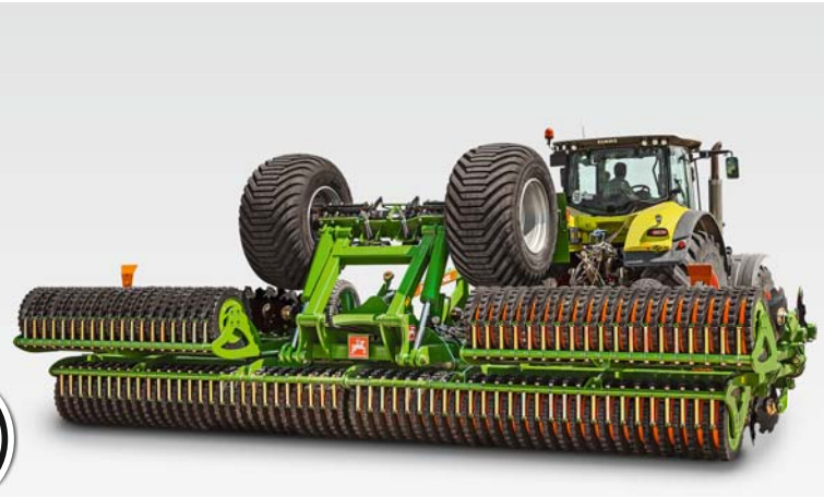
Reduzierung der Arbeitsbreite auf 7 m
