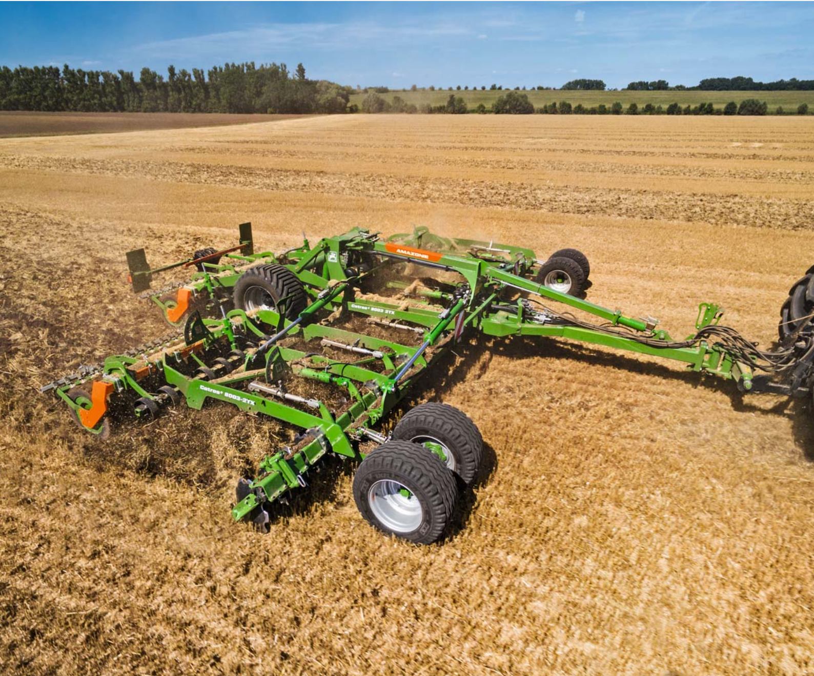
Catros + 8003-2TX mit Keilringwalzen mit Matrixreifenprofil in 8 m Arbeitsbreite
