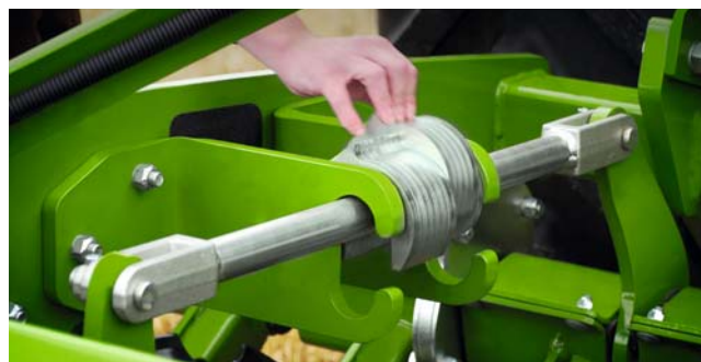
✔ Arbeitstiefeneinstellung durch Distanzelemente – hier mittlere Arbeitstiefe
