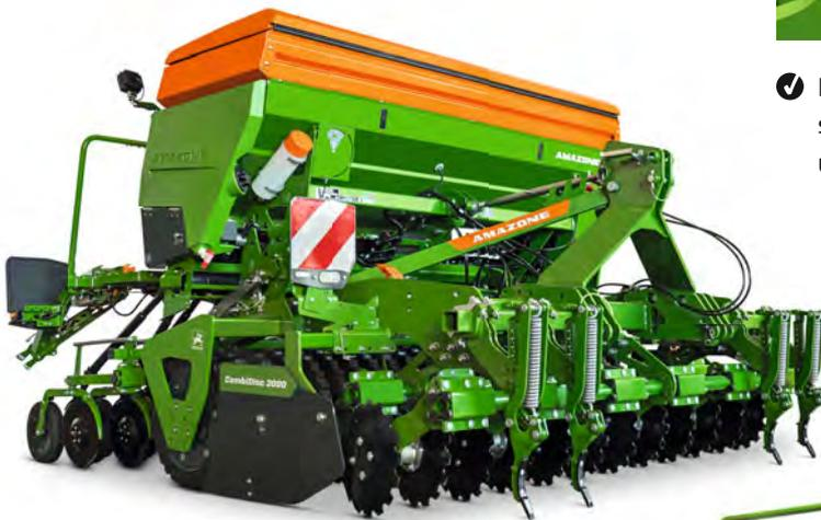
Anbau-Kompaktscheibenegge CombiDisc 3000 mit Aufbausämaschine Cataya 3000 Super
