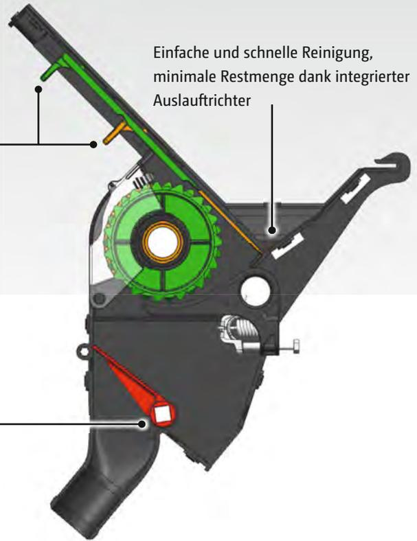
Einfache und schnelle Reinigung, minimale Restmenge dank integrierter Auslauftrichter
