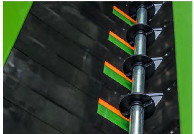
! „Durch die Integration der Dosierer einschließlich Trichter in den Tank kann das Saatgut besser nachlaufen. Die technische Restmenge ist gering, weil länger über die gesamte Breite genau gesät wird.“
