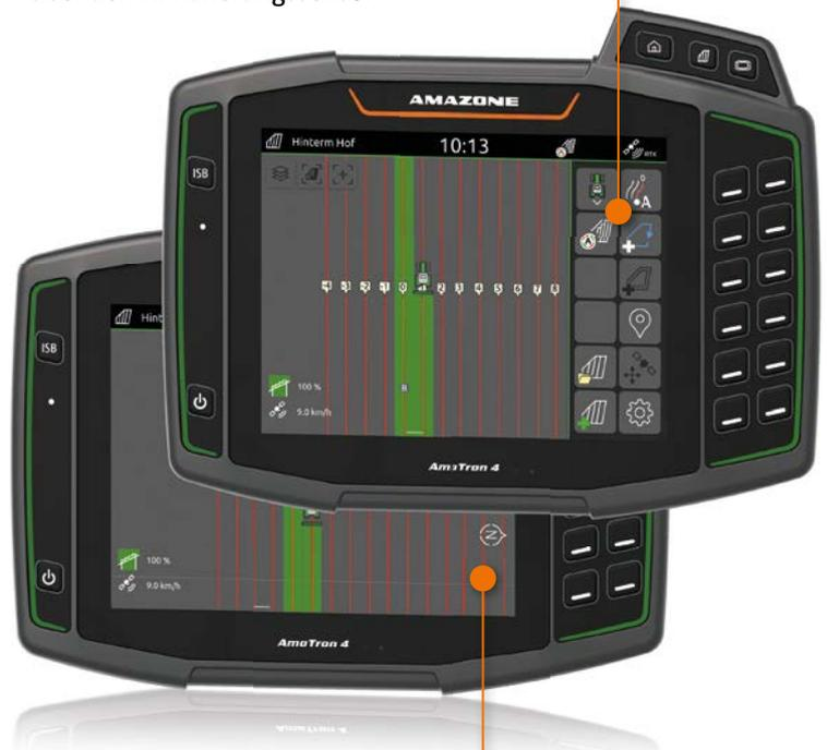
Automatisches Ausblenden der Schaltflächen zur optimalen Ausnutzung der gesamten Displayfläche
