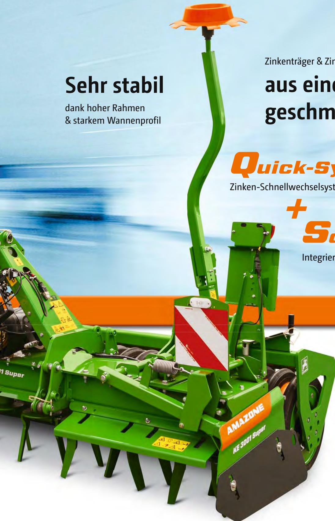
Die Kreiseleggen KE und die Kreiselgrubber KX und KG mit den Arbeitsbreiten von 3 m, 3,5 m und 4 m eignen sich ideal für den Soloeinsatz oder in Kombination mit einer Aufbausämaschine zur Saat. Ausgestattet mit der passenden Nachlaufwalze wird eine sehr gute Rückverfestigung erzielt.
