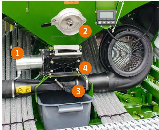
② **Schnellentleerung:** Die Entleerung des Saatgutbehälters von Saatgut erfolgt schnell und einfach über die Schnellentleerung die gut zugänglich am Saatgutbehälter angebracht ist.
