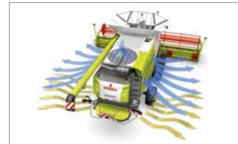
**Diesel sparen mit DYNAMIC COOLING.**
